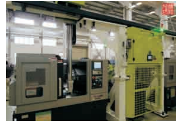
金石HUB20型一体式桁架机器人与数控机床的1:2配置组合。
