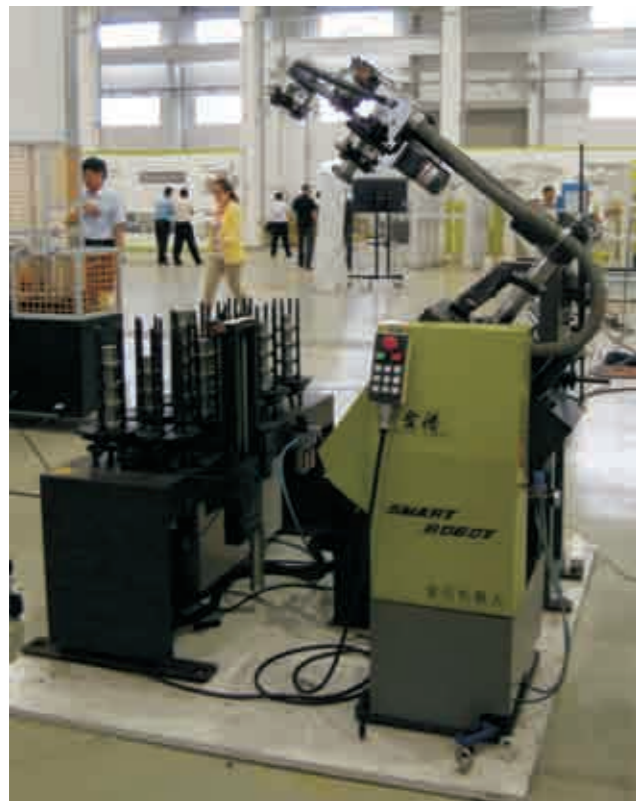
“金汤”牌SR型一体机，外号“招财猫”是一种比关节机器人结构简单的生产线物料搬运机器人。
