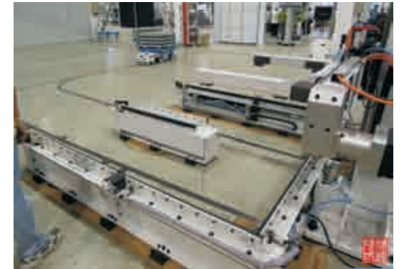
远处一辆载货小车沿着曲线自动款款走来,那叫做AGV(Automatic Guided Vehicle),即自动导引运输车,也称移动式机器人。
