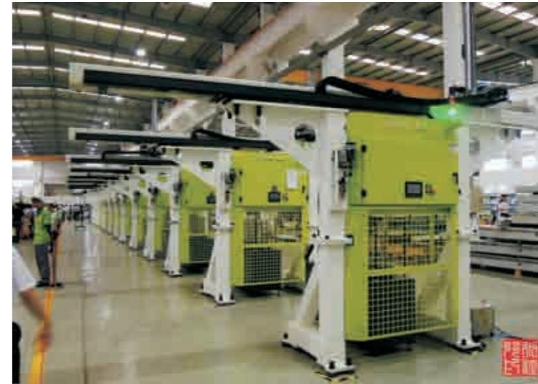
这里列队的是金石开发的热销产品——HUB系列一体式桁架机器人。
