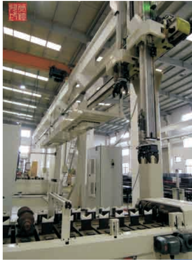
联体双手臂的抓手动作可交叉进行，以最短路径适应大型曲轴线的加工节拍。
