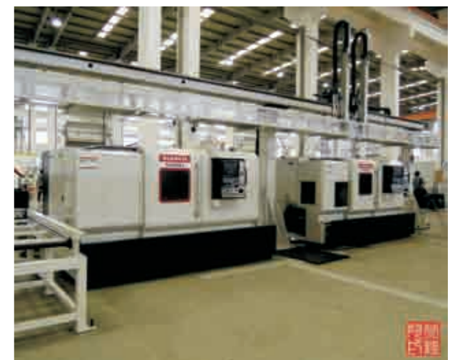
联体双臂桁架机器人与两台数控加工机床的组合安装。可见，工件应是从机床上方自动实现上下料。
