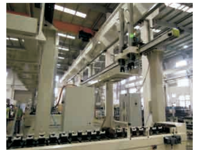
现场陈列的一架用于重型柴油机曲轴生产线上的联体双臂重型桁架机器人。
