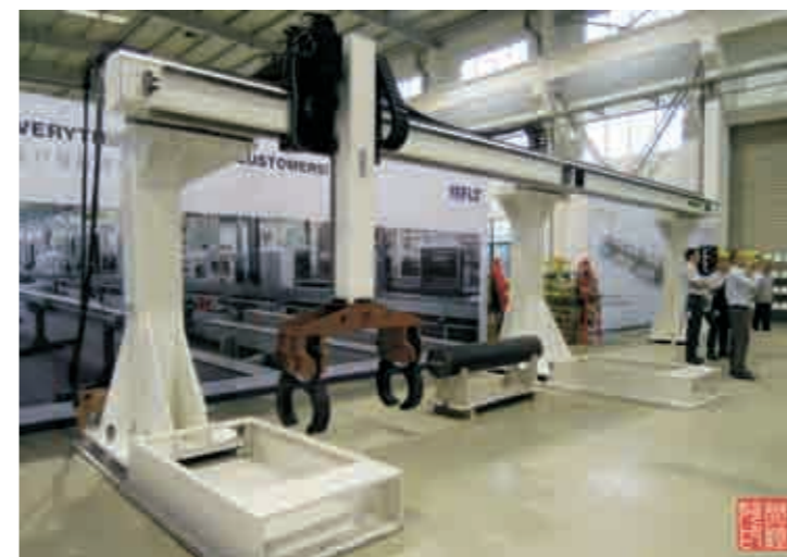
开幕式的会场后部，一架巨型桁架机器人立于墙边。看巨型砝码断面标注——1000KG,其总长超过10米，有三个立腿。
