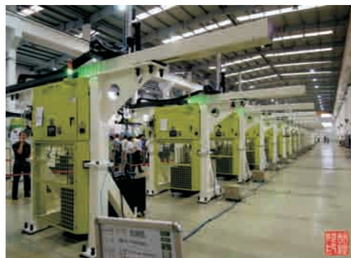
金石桁架机器人的总装生产线
