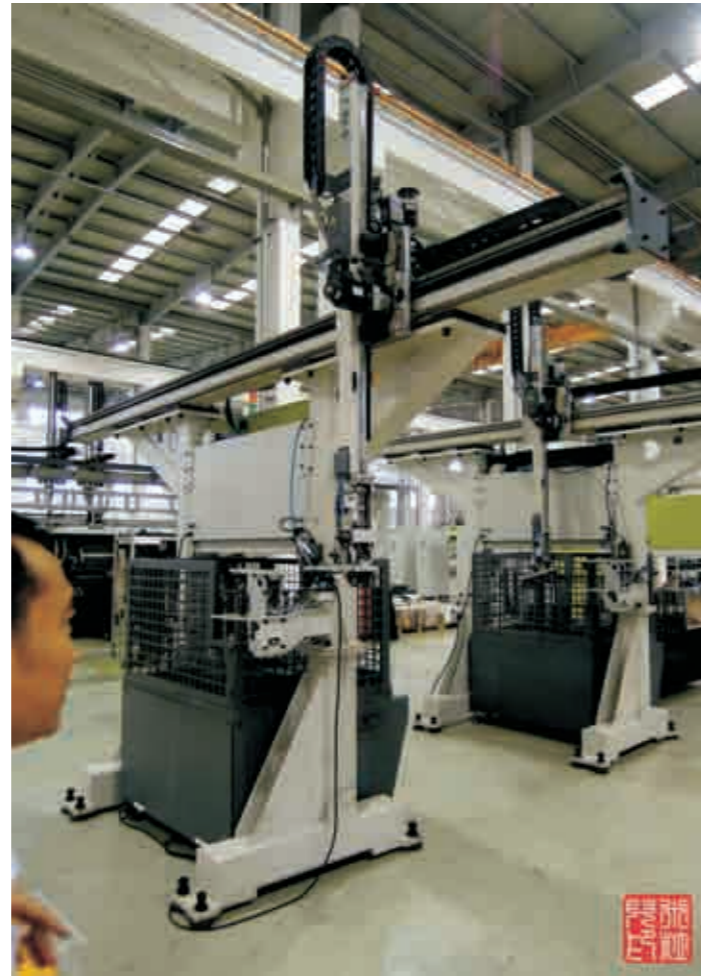
生产现场调试线上的金石一体式桁架机器人
