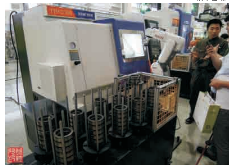
这台数控机床前是一架白色的关节机器人,金石邀请了同在常州的另一家机床厂的设备来一同参与演示。着草绿工作服的KEMT公司员工正在为宾客解答。
